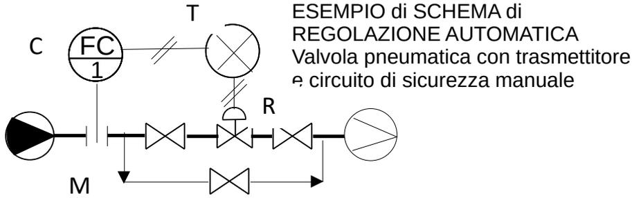
MISURATORE / CONTROLLORE / TRASMETTITORE / ATTUATORE-REGOLATORE
